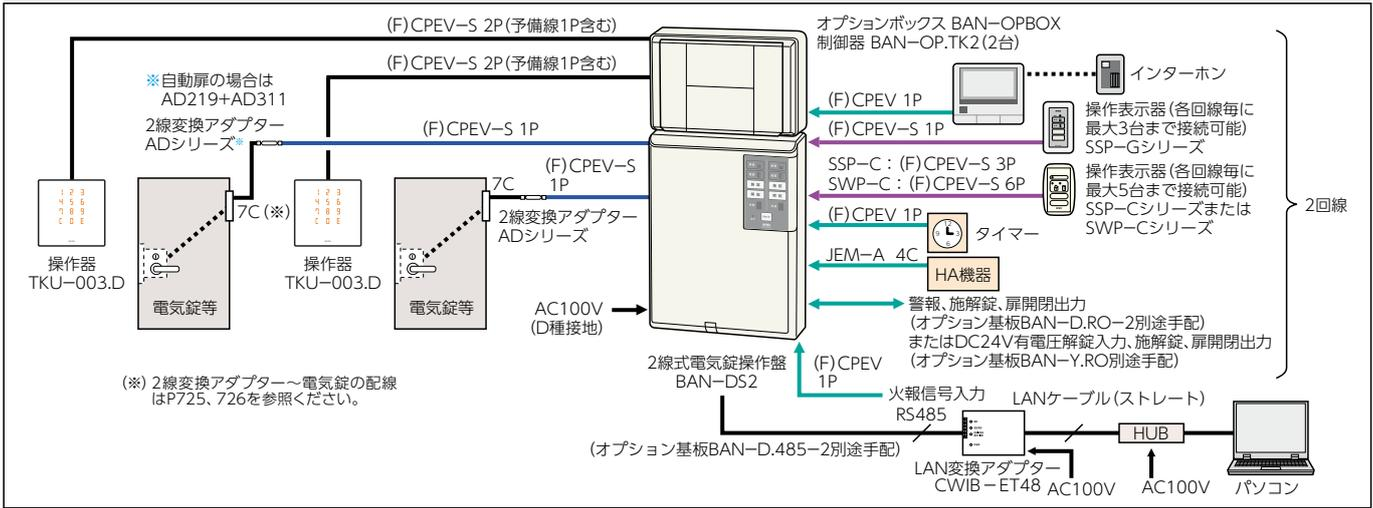
■システム構成図 (インターロック制御の使用例)
